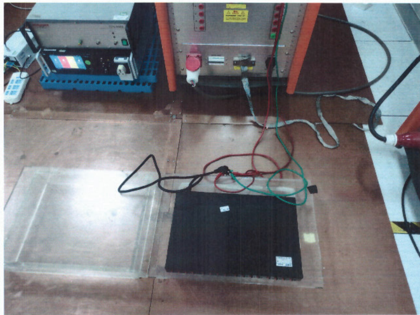
图三：浪涌（冲击）抗扰度检测布置图
